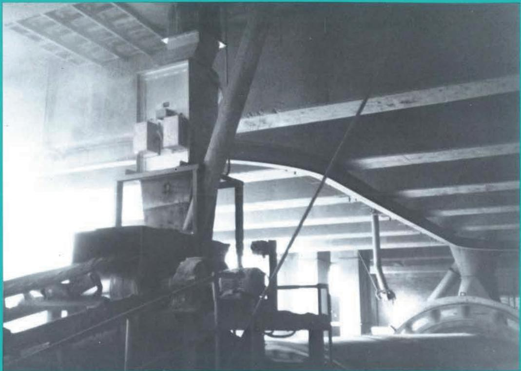
写真は、セパレータからの戻り粉の流量を検出するインパクトライン流量計ILS型発信器です。
