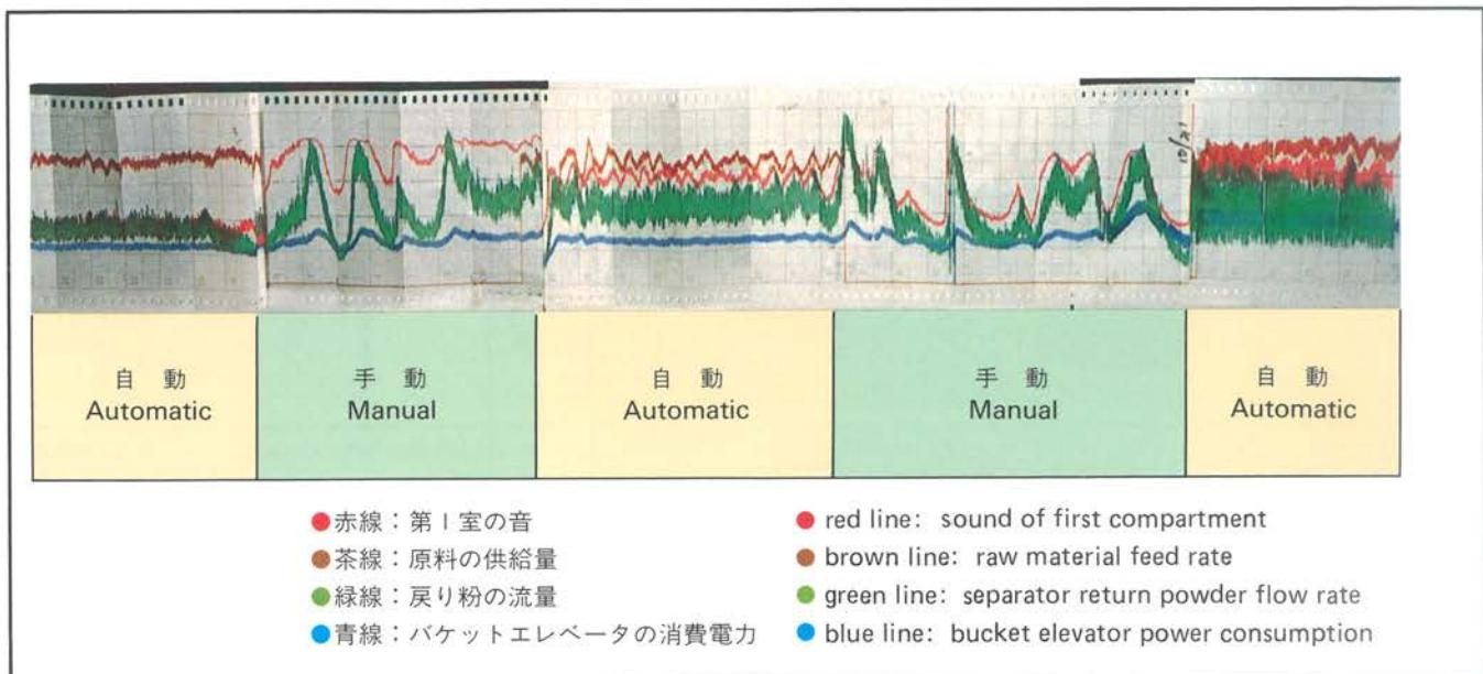
セメント用仕上ミルを、ミルコン SSPFM型により自動運転した場合と、手動運転の場合の結果を示しています。自動運転の場合、バケットエレベーターの電力および戻り粉の流量が安定しているのがわかります。
