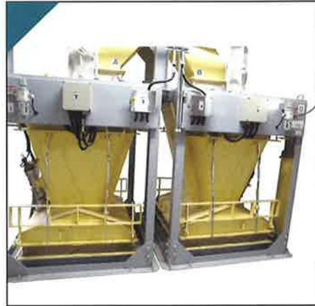
精油工場で大豆原料の計測用に利用 大流量用 SA-05型
