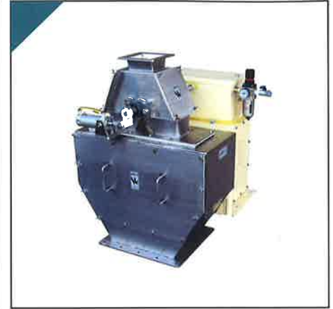
そば工場でそば粉の計測用に利用 小流量用 SM-05型
